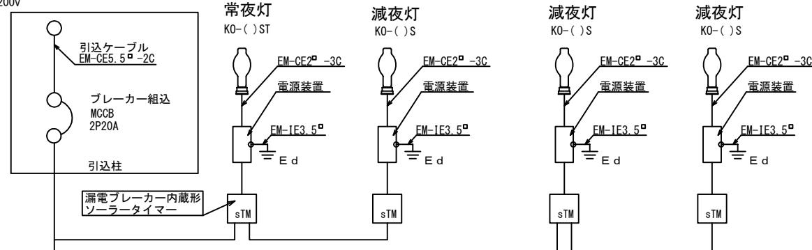
ボール内蔵型ソーラータイムスイッチ 点灯・消灯時間の設定は打ち合わせによる。
