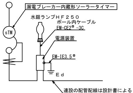
ボール内蔵型ソーラータイムスイッチ 点灯・消灯時間の設定は打ち合わせによる。
