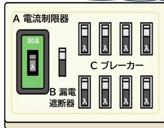
A電流制限器とCブレーカー切れている ⇨ AとCを【入】⇨復旧
