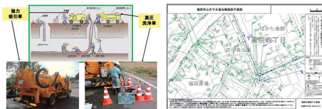
図 4. I . 2 下水道管路施設の維持管理と下水道台帳システム
