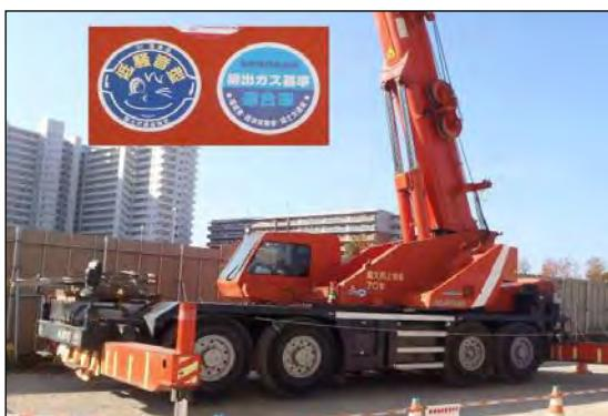
写真②-5 低騒音型建設機械の使用状況
