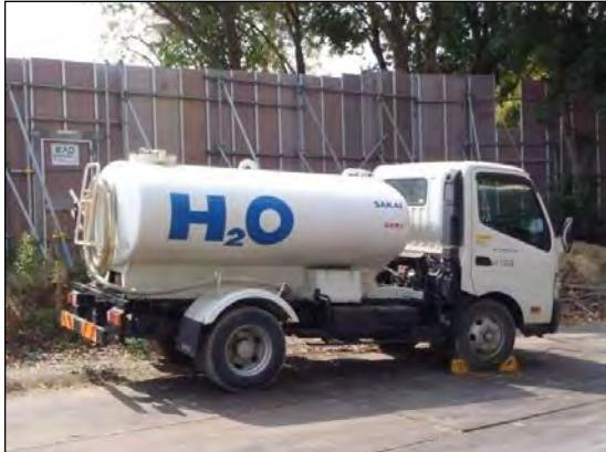
写真①-1 施工ヤードへの散水設備
