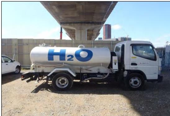
写真②-1 施工ヤードへの散水設備
