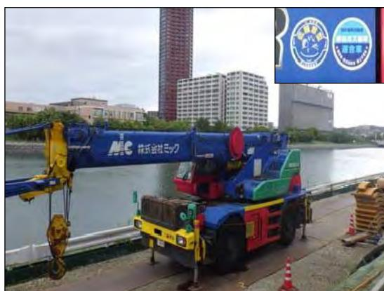
写真③-7 低騒音型建設機械の使用状況
