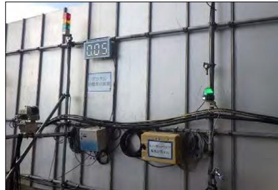
写真③-2 粉じん表示計による確認
