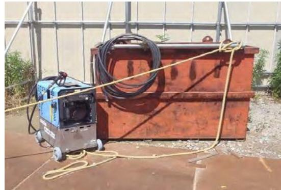
写真②-6 工事用車両のタイヤ洗浄設備
