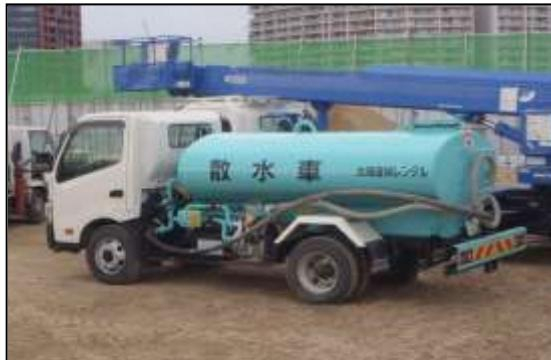
写真③-1 施工ヤードへの散水設備
