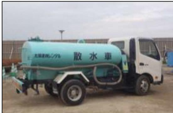
写真②-1 施工ヤードへの散水設備
