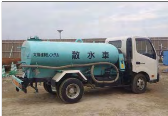
写真②-1 施工ヤードへの散水設備
