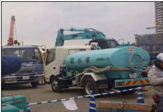
写真③-1 施工ヤードへの散水設備
