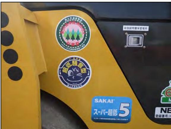
写真③-3 低騒音型建設機械の採用
