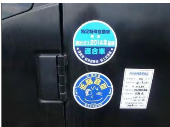
写真②-3 低騒音型建設機械の採用
