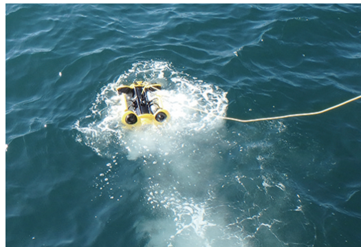
水中ドローンによる調査
