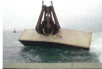
Grabバケットによる揚収 作業（揚収物が破損す る可能性がある）
