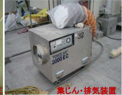
隔離＋集じん・排気装置を使用する方法
