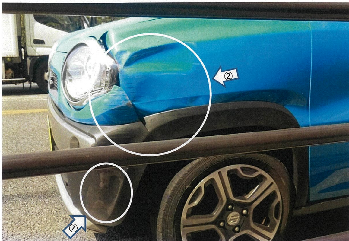
①左フロントバンパーの損傷 ②左フロントフェンダーの損傷
