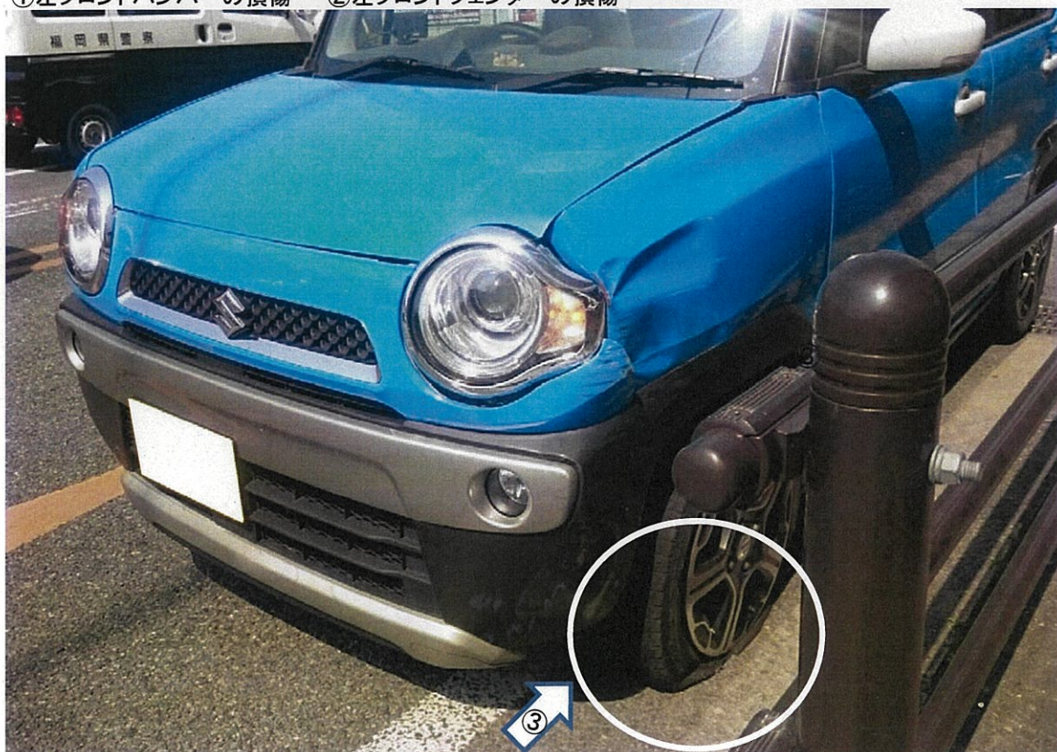
③左フロントホイール・タイヤの損傷
