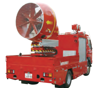
● 大型ブローカー車(1台) トンネルなどの火災のとき、煙や有毒ガスを風で外に出します。
