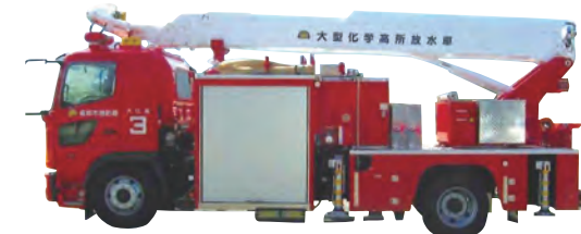
● 大型化学高所放水車(2台) 飛行機の火災など大きな油火災のときに、22メートルのびるはしごの先からあわを出して消火します。
