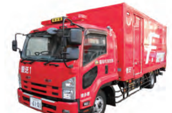
● 資機材搬送車(1台) 山火事や地下街火災など大きな災害に山林ポンプ、呼吸器ポンペなどを運びます。
