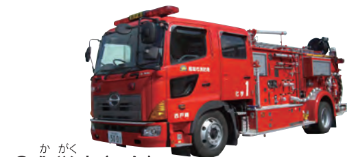
● 化学車(2台) 水では消えない油火災のとき、あわを使って消火します。
