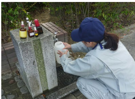
給水栓の採水
