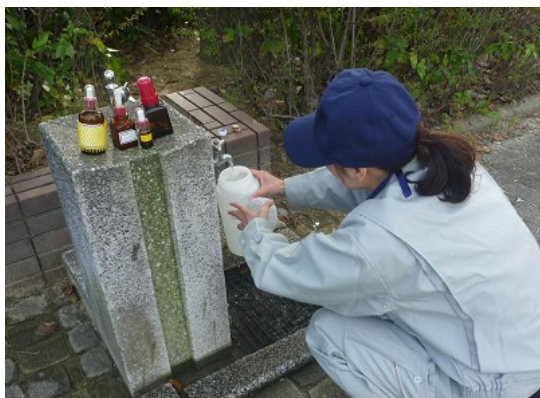
給水栓の採水
