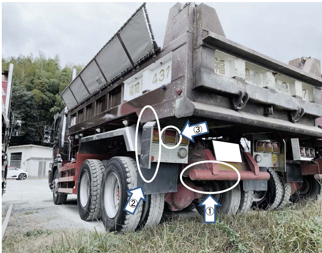
①リアバンパーの塗装の剥離 ②左テールランプブラケットの変形 ③左テールウinkerレンズの割れ
