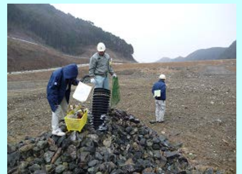
埋立場の発生ガス調査
