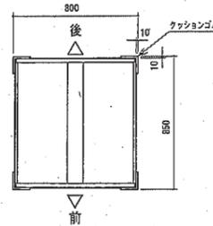
リフト用運搬車 側面図 S=1/20
