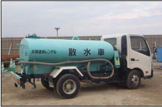
写真②-1 施工ヤードへの散水設備
