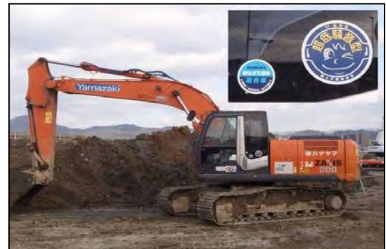
写真②-4 低騒音型建設機械の使用状況
