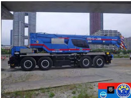
写真③-5 低騒音型建設機械の使用状況
