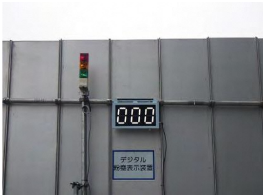
写真③-3 粉じん計による測定状況
