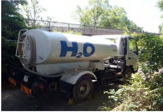
写真①-1 施工ヤードの散水設備
