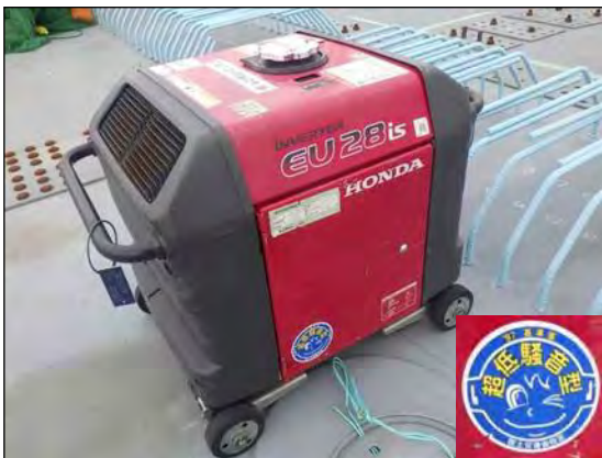
写真④-5 低騒音型建設機械の使用状況 (2)
