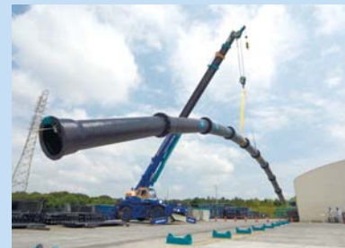
耐震管吊り上げ実験の様子 耐震管は、管のつなぎ目が伸び縮みすることで、揺れに対応できます。
