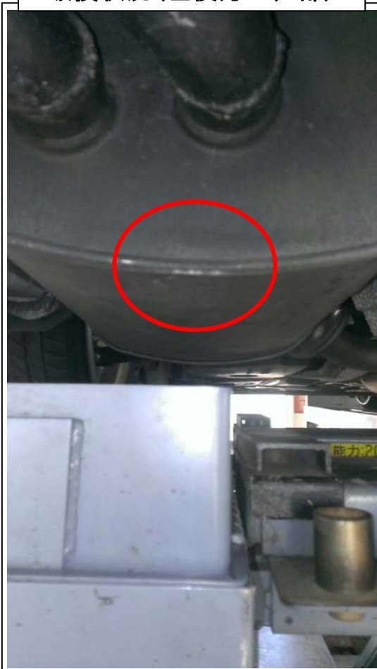
破損状況(左後方マフラー部)
