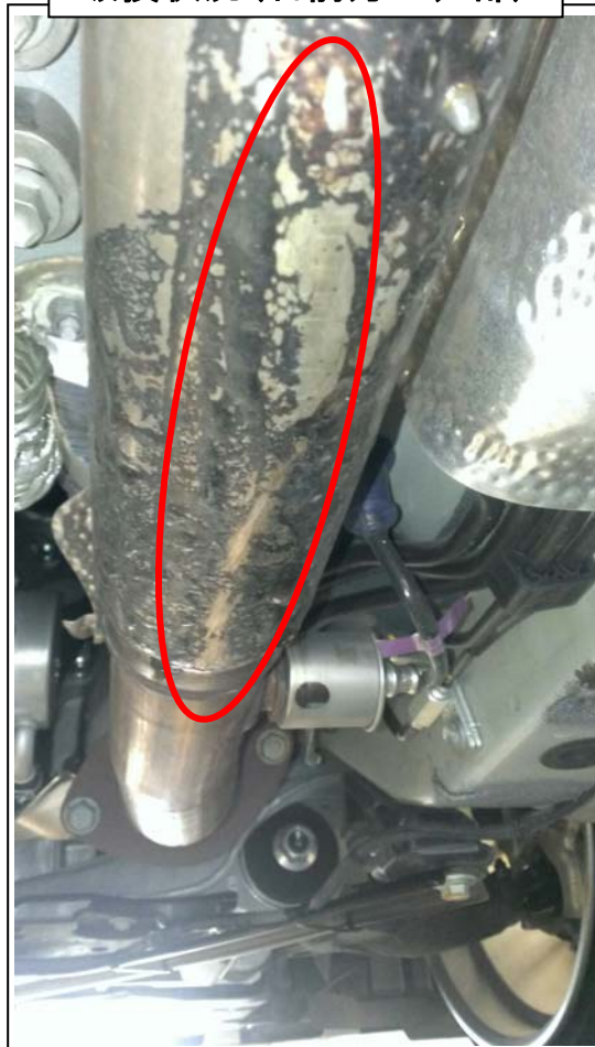
破損状況(右前方マフラー部)
