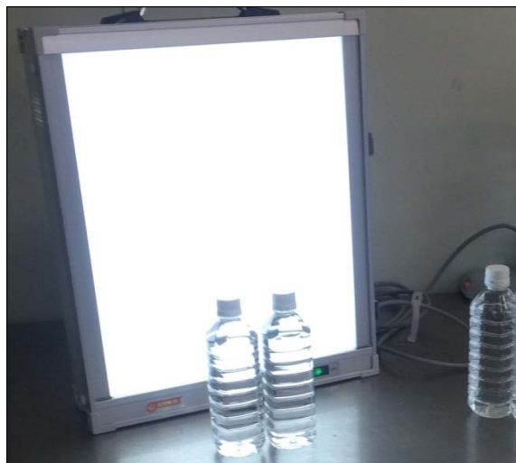
写真-7 照明器具を用いた 新たな目視検査
