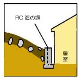
想定される土石流の高さや衝撃力に応じて定められた仕様を 満たす鉄筋コンクリート造の外壁等を設ける
