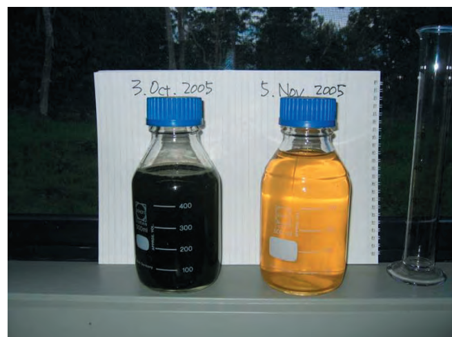
浸出水原水と改善後の浸出水原水(2005年)
