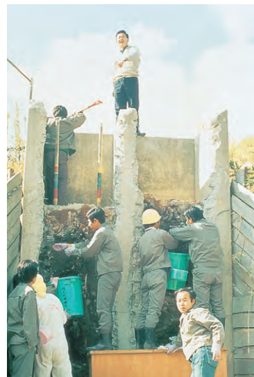
福岡大学における埋立模型槽による実験 (1974年)
