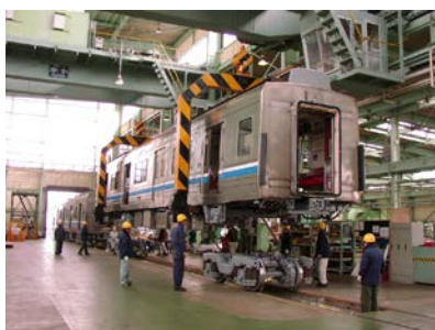
車両重要部検査
