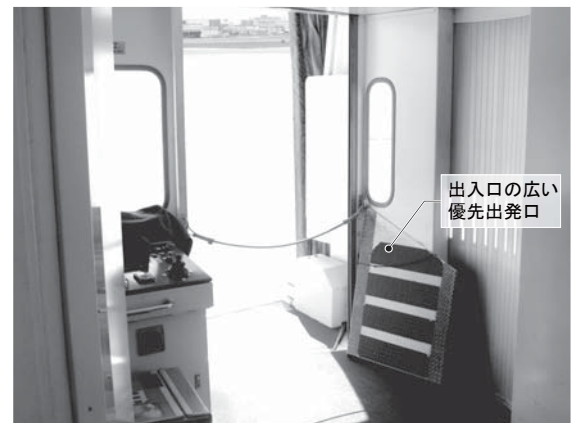
搭乗橋と飛行機を連結する渡り板の例
