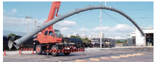
「耐震管」のつり上げ実験の様子
