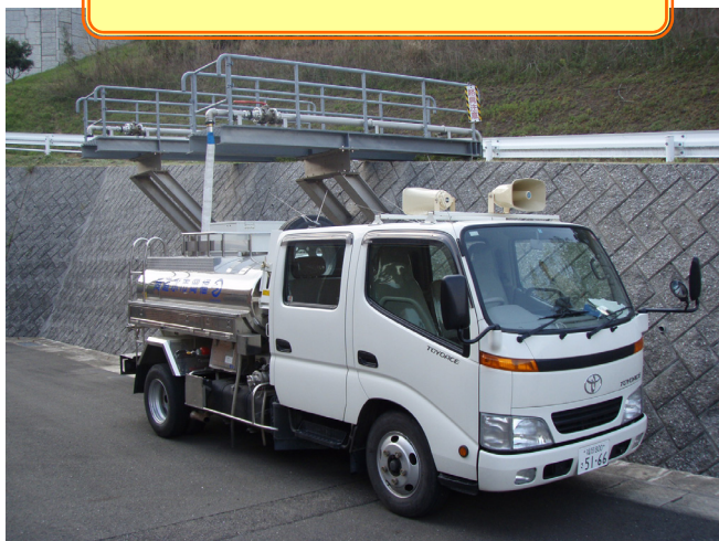
羽根戸配水場の注水設備と給水車
