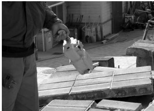
玄界島におけるガス管やメーターの被害
