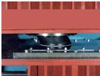
弾性すべり支承実験状況 (建設企業 開発)
