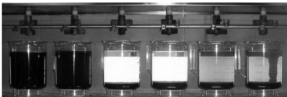
図2 堆肥化物抽出液と液体墨の模擬汚水の PAC ジャーテストの様子 PACの添加濃度は、左から順に 0, 15, 30, 60, 90, 120mg/L
