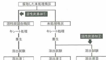
図1 飛灰のキレート処理に対する活性炭の影響調査の実験概要
