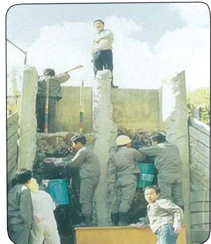
福岡大学における埋立模型槽による実験
