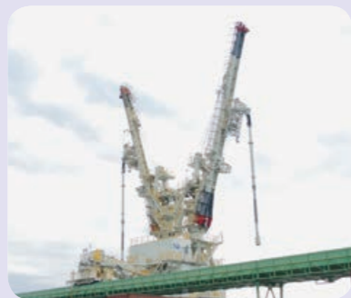
●アンローダ 船で運ばれてきた穀物はアンローダで吸いあげられ、ベルトコンベアーに乗って、サイロ（穀物倉庫）に送られます。
